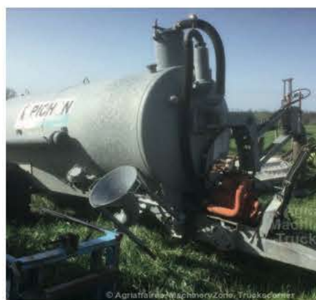
Exemple Tonne à lisier Pichon Volume 6 000 L Poids à vide : 2T - Essieu à plein 5T Pneu 385/65 R22.5 Poids : 4.7 kg/cm² sur 1052 cm² / 2 pneus
