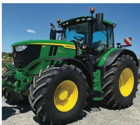
Exemple John Deere 195R Puissance 200 cv Poids à vide 8.6T - essieu AV 2.8T - AR 5.8T Pneu 650/85 R38 AR et AV 600 70R28 Poids : 0.87 kg/cm² sur 6648 cm² / 2 pneus
