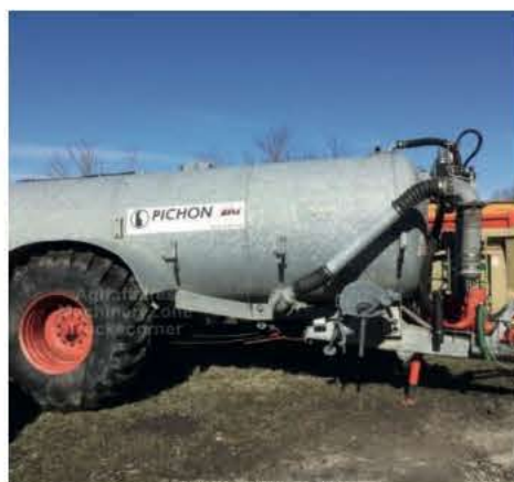
Exemple Tonne Pichon Volume 10 500 L Poids à vide : 5T - Essieu à plein 13T Pneu 800/65 R32 Poids : 2.15 kg/cm² sur 3016 cm² / 2 pneus
