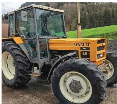
Exemple Renault 85 - 14 LS Puissance 85 cv - poids à vide : 3.6T Essieu AV 1.5T - AR 2.1T Pneu 480/70 R34 AR et 380/70 R24 AV Poids : 0.87 kg/cm² sur 2412 cm² / 2 pneus
