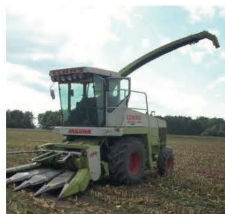
Exemple Claas 690 Cueilleur 4 rangs - Puissance 300 cv Poids total 9T - Essieu AV 6T - AR 3T Pneu 540/65 R30 AV et 420/65 R20 AR Poids : 1.4 kg/cm² sur 4168 cm² / 2 pneus
