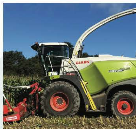
Exemple Claas 940 Cueilleur 8 rangs - Puissance + 500 cv Poids total 16T - Essieu AV 10 T - AR 6 T Pneu 800/70 R32 AV et 600/65 R28 AR Poids : 1.1 kg/cm² sur 9254 cm² / 2 pneus
