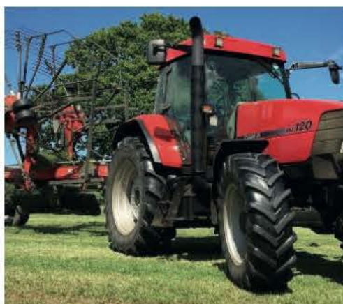
Exemple Case MX 120 Puissance 120 cv Poids à vide : 6.2T - Essieu AV 2.7T - AR 3.5T Pneu 580/70 R38 AR et 480 70 R28 AV Poids : 0.96 kg/cm² sur 3660 cm² / 2 pneus
