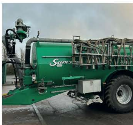
Exemple Tonne à lisier Samson Volume 18 000 L Poids à vide 12.1T - Essieu n°1 5.5T n°2 6.5T Poids à plein 30T - Essieu n°1 13.3T n°2 13.7T Pneu 750/60 R 30.5 Poids : 2.6 kg/cm² sur 5250 cm² / 2 pneus
