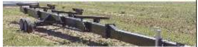
PORTE-COUPÉ MOISSONNEUSE BÂTEUSE système de feutrage par inertie, hydraulique et trio de coupe.
