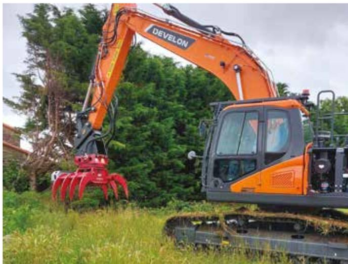
L'équipement est constitué d'une pelle à chenille de 23 tonnes Develon et d'une pince d'abattage de marque Vosch équipée d'un guide chaîne.
