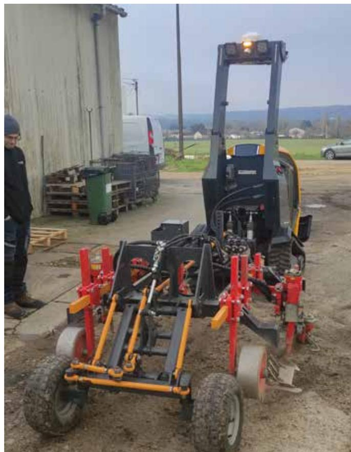
Pour cet essai, c'est sur du travail du sol que sera évalué le robot. Ce robot Pellenc RX20, en développement chez LVVD et qui n'est pas encore commercialisé, est capable de travailler en toute autonomie sans présence humaine.
