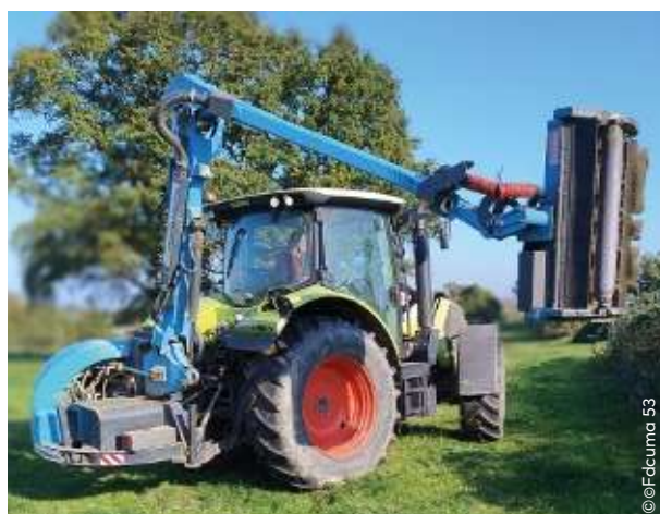
Le moteur de la débroussailleuse électrique affiche une puissance de 33 kW.
