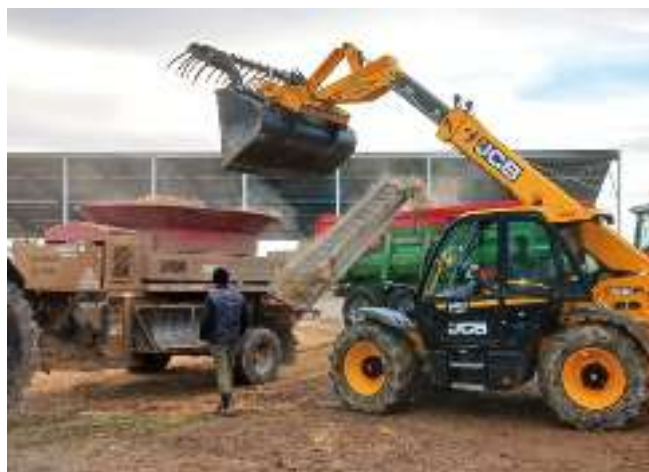
Le broyeur défibre en moyenne 7 tonnes de paille à l'heure. Plusieurs tailles de grilles sont disponibles en fonction du produit voulu.
