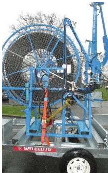
La cuma départementale Défis 85 propose son matériel de débouchage de drains sur une remorque pour voiture. C'est un atout qui facilite le déplacement entre les différents utilisateurs des cuma adhérentes.
